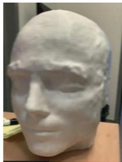
图6: 从结构性MRI数据集中获得的3D打印头部模型，用于开发锚定程序。
